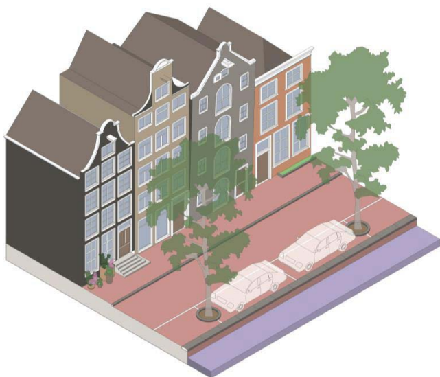
figuur 2.1 Kades: waterkanten die zijn ingericht met een verticale kademuur, beschoeiing of damwand
