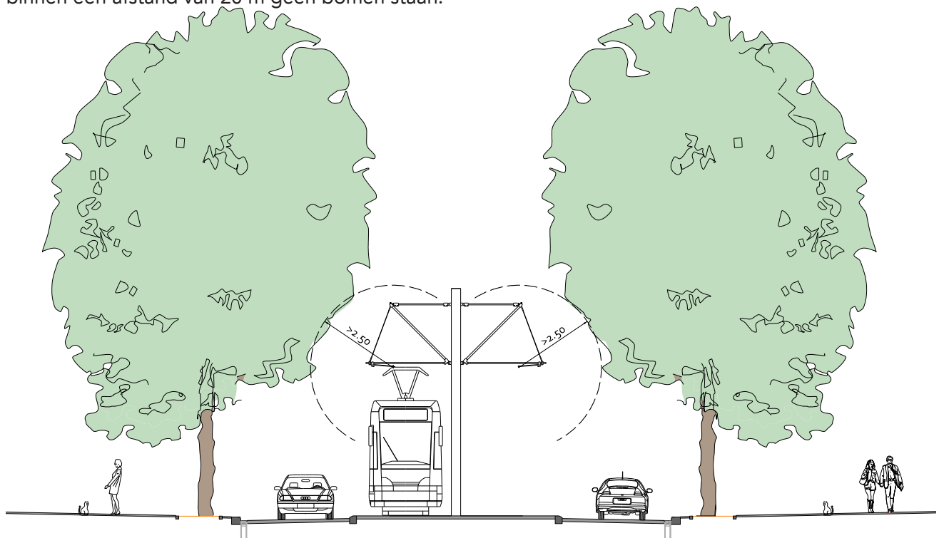
figuur 4.15 Profiel van vrije ruimte trambaan
