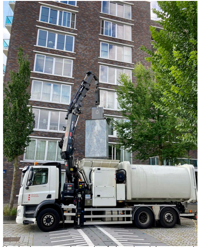
Voor het legen van ondergrondse afvalcontainers is bovengronds voldoende ruimte nodig (foto: Herman Best)
