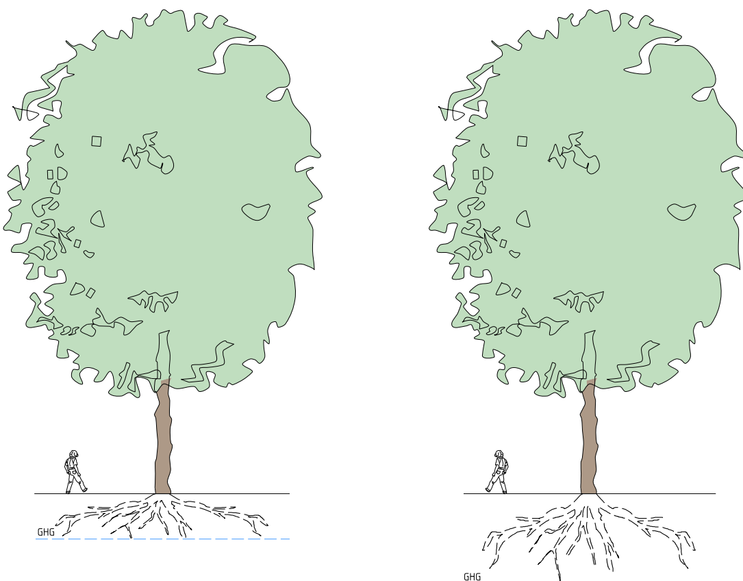
figuur 4.25 Wortelkluitontwikkeling bij grondwaterprofiel (links) en hangwaterprofiel (rechts)
